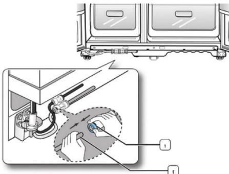
۲. لوله آب پایینی به طور کامل تا مرکز بست جفت کن شفاف وارد شده تا از نشت آب از بخش گر جلوگیری شود.
