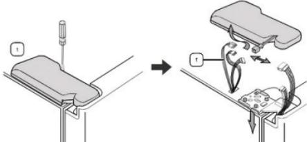
۱. به هنگام بسته بودن درب فریزر در پوش لولای بالای ۱ را با هاستفا را یک پیچ گوشتی خارج کنید و سیم سیم ها را به زامیا بیرون کشیده و انصال انها را قطع کنید. ۲
